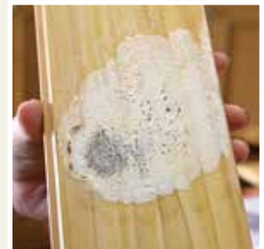
ガラス系塗装 ファインクリスタルシリーズ 燃焼実験
