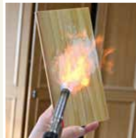
ガラス系塗装 ファインクリスタルシリーズ 燃焼実験
