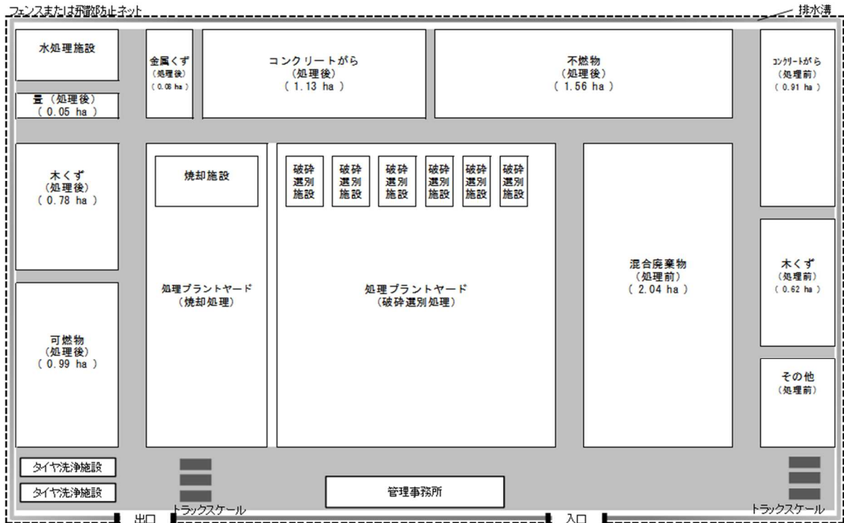
図表 3-27 機械選別や焼却処理等を行う二次仮置場のレイアウトイメージ
