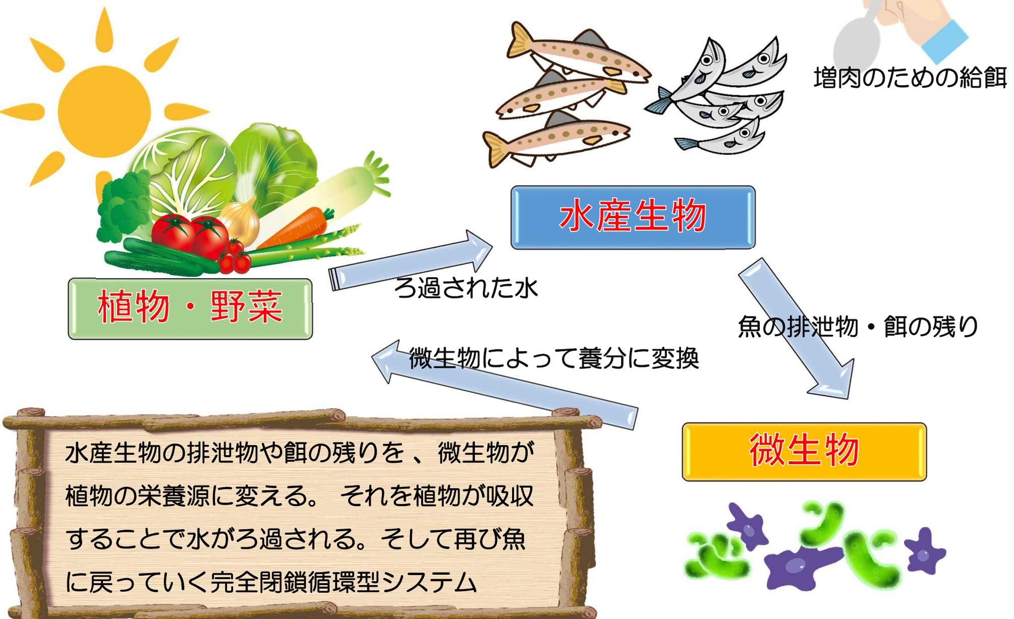
水産生物の排泄物や餌の残りを、微生物が植物の栄養源に変える。それを植物が吸収することで水がろ過される。そして再び魚に戻っていく完全閉鎖循環型システム
