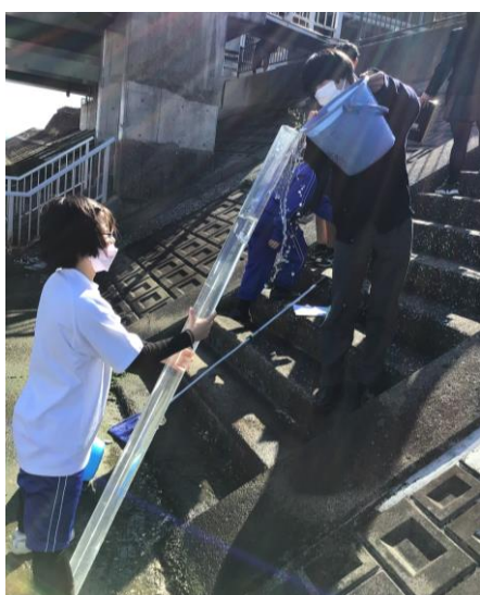
写真3 自作透視度計を使った透視度の測定
