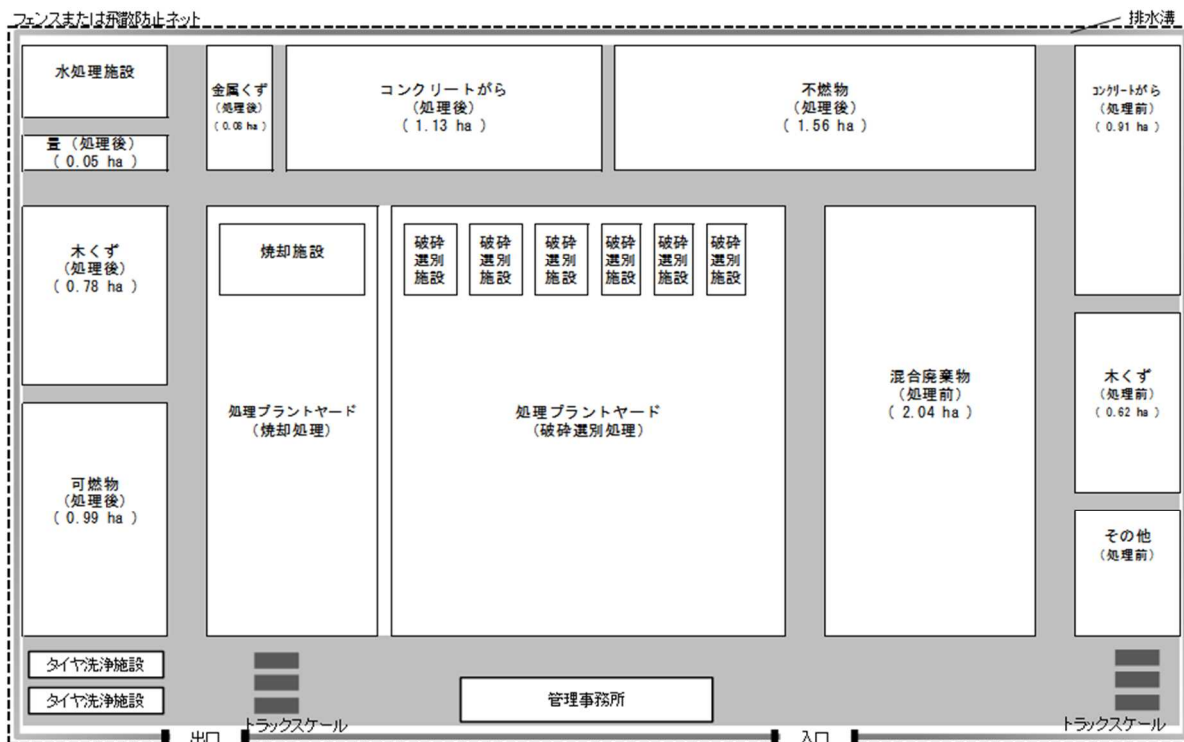
図表 3-27 機械選別や焼却処理等を行う二次仮置場のレイアウトイメージ
