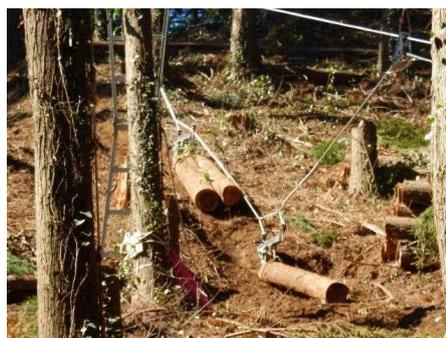
また、下げ荷搬出試験では「マッシュプーリー」と「修羅 iido」、「改良型修羅 iido」を使用したところ、「マッシュプーリー」が最も多くの材を搬出したのに対し「修羅 iido」や「改良型修羅 iido」では重い材の搬出は不向きであることが分かりました。
