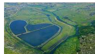
↑遊水地として治水機能を確保すると共に、水質改善や生態系保全にも寄与(渡良瀬遊水地)
