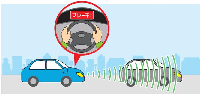
車載レーダー等により前方の車両や歩行者を検知し、衝突の可能性がある場合には、運転者に対して警報します。さらに衝突の可能性が高い場合には、自動でブレーキを作動します。
