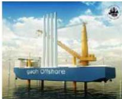
3.6MW 級運搬据付用専用船(欧州)
