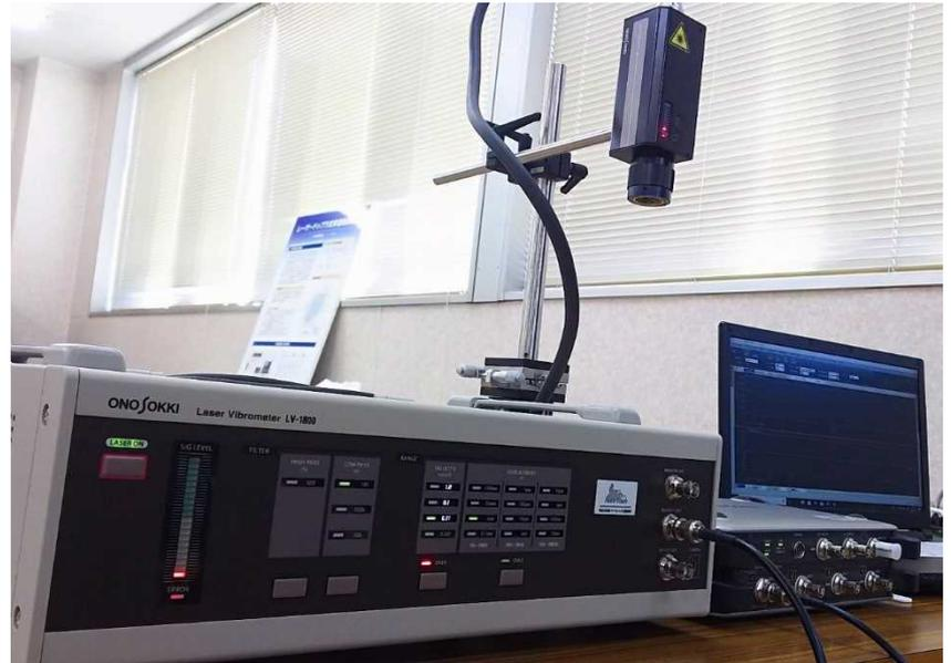
レーザードップラ式非接触振動計 外観
