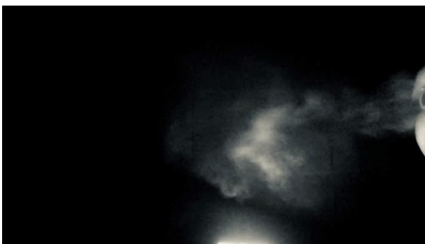
図7 葉脈デザインと各羽根のひねりをそれぞれ変えた（5枚不均等）羽根の気流（モデル TCLv）
