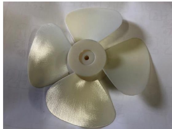
図1 3Dデータを取得してリ・プロダクトした羽根
