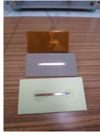
図3 上TF-6C, 中PTFE基板, 下FR4基板
