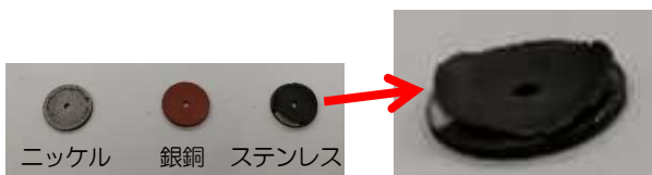
図4 ステンレス膜の剥離
