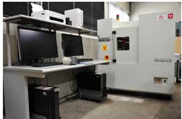
写真 2 高精細 X 線 CT 装置
