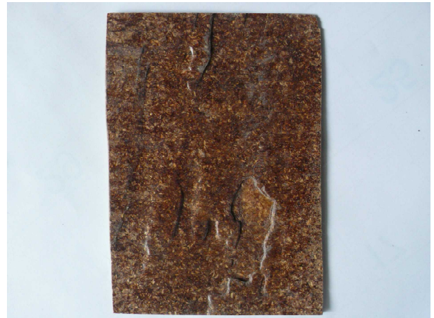
図. 3 バイオマスペレットを用いた試作品
