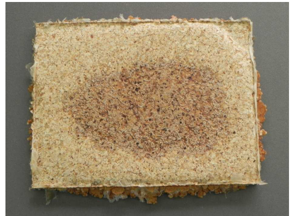
写真 1 水分の残留した PHP ボード
