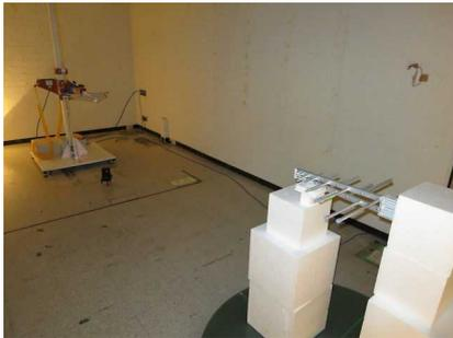
写真3 ログペリアンテナ水平偏波
