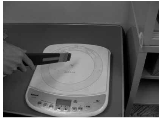
図2 IH調理器の磁界強度測定
