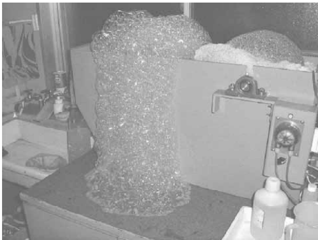
図9 ばっ気槽からの異常発泡 (水酸化ナトリウムを用いた条件で前段処理)
