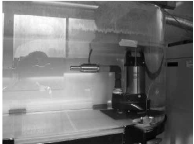
図2 オゾンマイクロバブル処理槽
