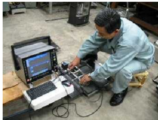
図6 TOFD装置 (UTステーション) による計測
