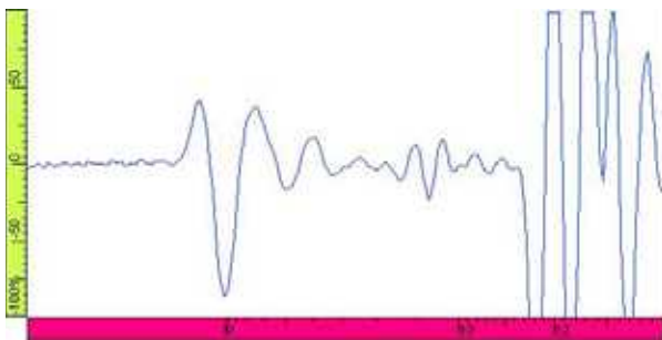
図 1-7 12t 試験体 ④による代表きず部波形
