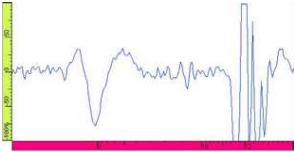
図 1-1 12t 試験体 ①による代表きず部波形
