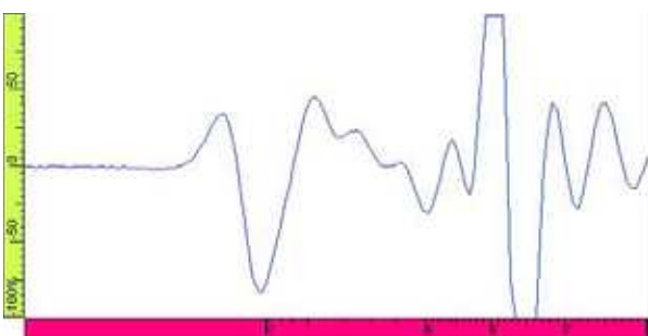
図 1-29 6t 試験体 ⑨による代表きず部波形
