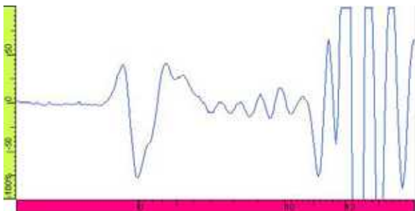
図 1-17 12t 試験体 ⑨による代表きず部波形
