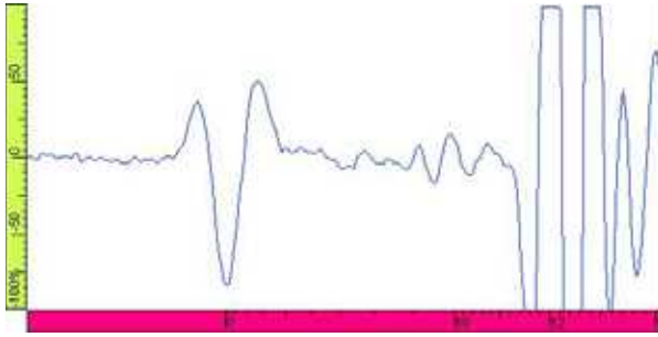
図 1-3 12t 試験体 ②による代表きず部波形
