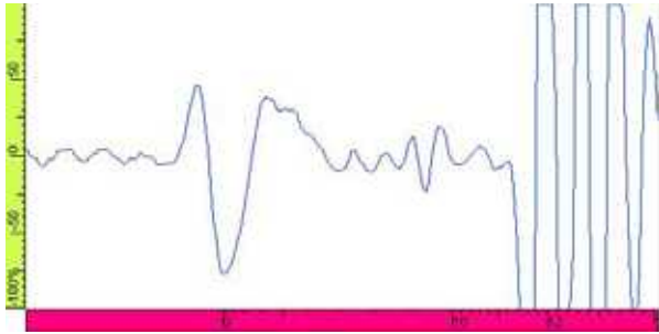
図 1-11 12t 試験体 ⑥による代表きず部波形
