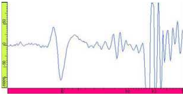
図 1-5 12t 試験体 ③による代表きず部波形
