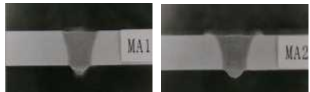
溶接開始側 溶接終止側 写真6 Arガスシールド溶接部の断面形状
