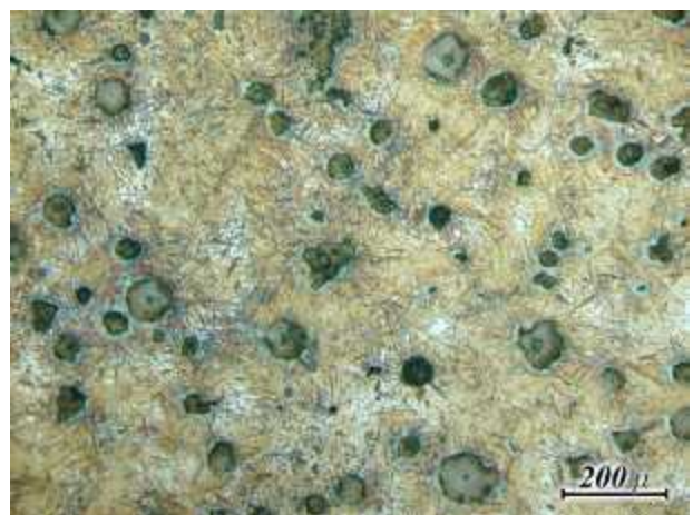
写真6 : 1,000°C, 240分保持, 水冷 (条件4)
