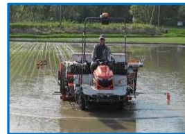
直進アシスト田植機による 移植作業
