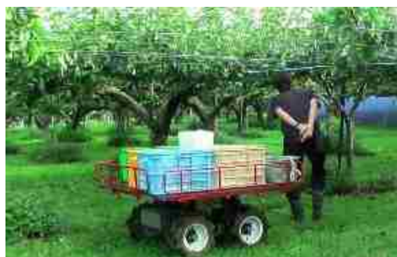
ロボット作業車による日本なしの収穫作業の省力化
