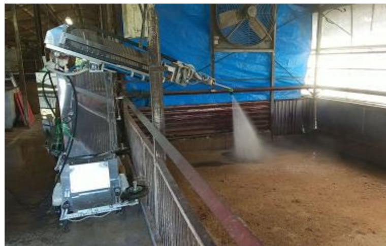
畜産総合研究センターで開発協力した畜舎洗浄ロボット(試作機)
