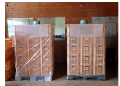
ビニールで被覆した上で、換気扇を設置し、通風乾燥を行う簡易乾燥技術
