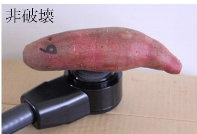
写真2 近赤外吸光度の測定方法
