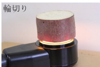
写真2 近赤外吸光度の測定方法
