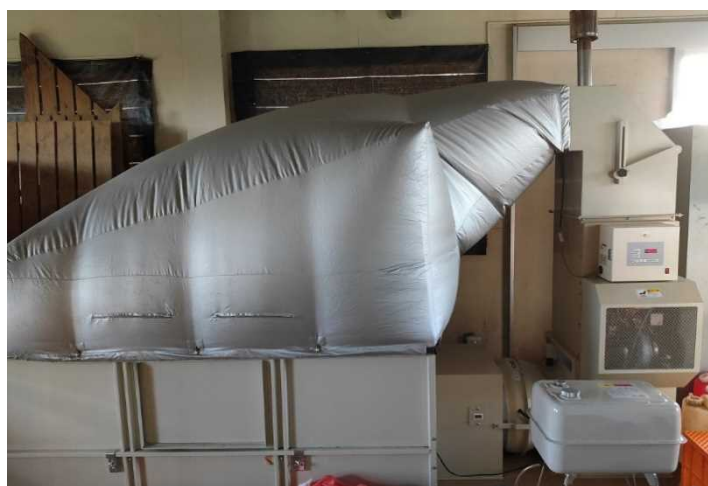
写真2 平型乾燥機 HED330（金子農機製）
