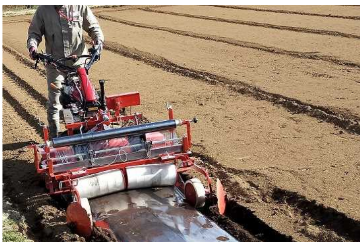
写真 1 歩行式シーダーマルチ SDS95N-Y（総和工業（株）社製）
