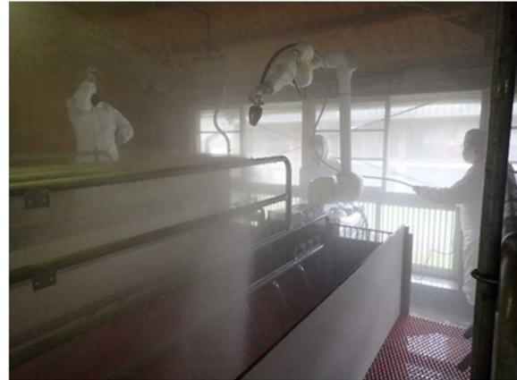
図1 豚舎用洗浄ロボット（左、肥育豚舎用 右、分娩豚舎用）
