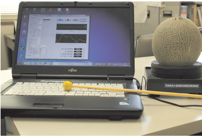
写真1 固有振動数（左）及び果肉硬度（右）の測定
