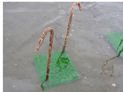
写真3 人工芝(鉄筋を通じ上下に遊動)
