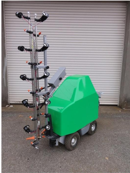
図1 エアアシスト静電防除機（試作3号機）
