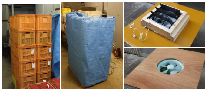
写真3 試作した予備乾燥用簡易乾燥装置
