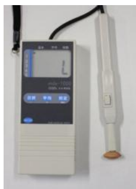
写真1 落花生子実の簡易水分計による水分測定の様子
