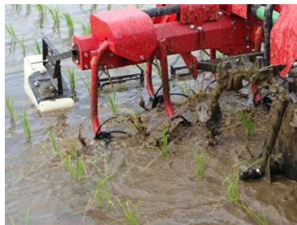
②水稻を傷めないように水田土壌を攪拌する回転部を調整して実施
