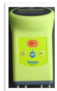
写真1 電気抵抗を利用した品質測定機器の試作機
