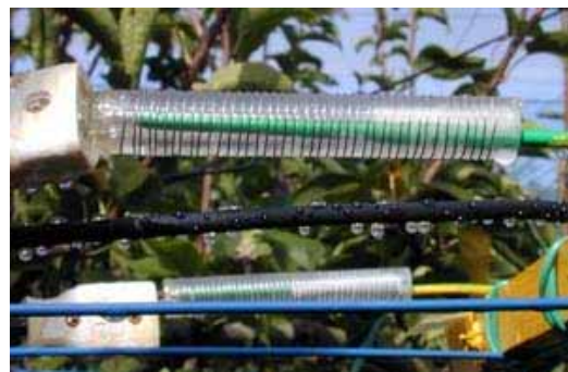
写真1 葉の濡れの有無を推定するセンサー
