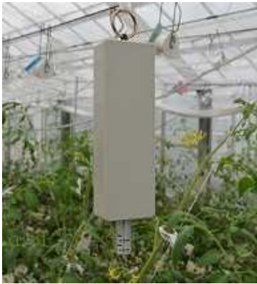
写真4 結露センサー ハウス内に吊るして使用 気温と結露値を測定
