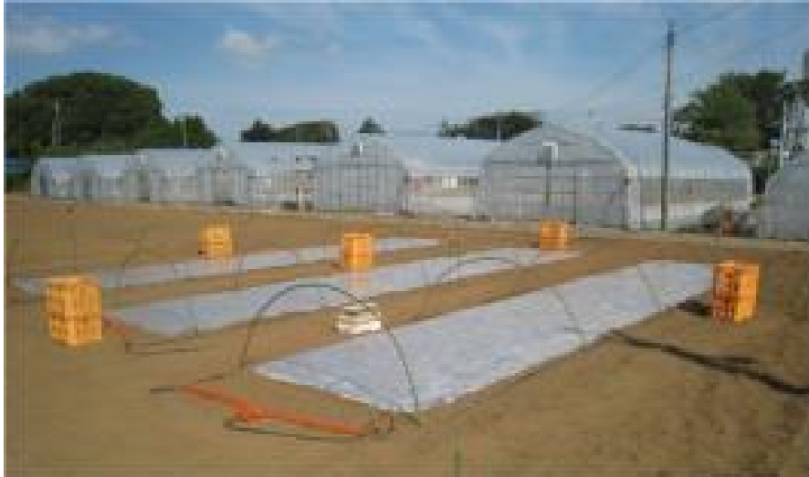
写真 2 大気中の MITC 濃度の測定状況
