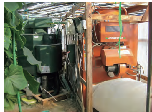
写真1 炭酸ガス発生器(左)の吹き出しをハウス加温機(右)の吸気口に向けて施用する
