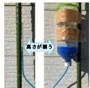
写真2 簡易水準器 （水盛り）の例
