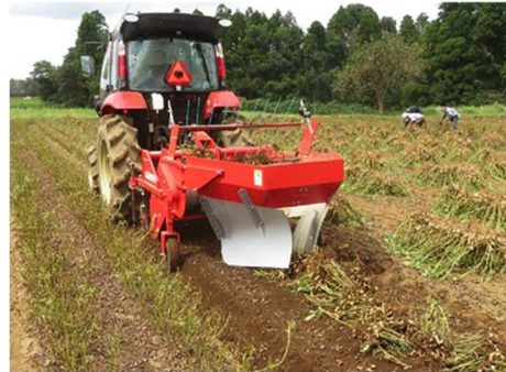
ラッカセイ掘取機の改良機による掘り取り作業
