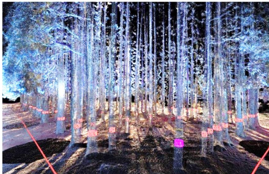
地上レーザ計測による3D点群データ
