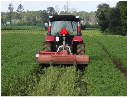
フレールモアによる茎葉切除作業
