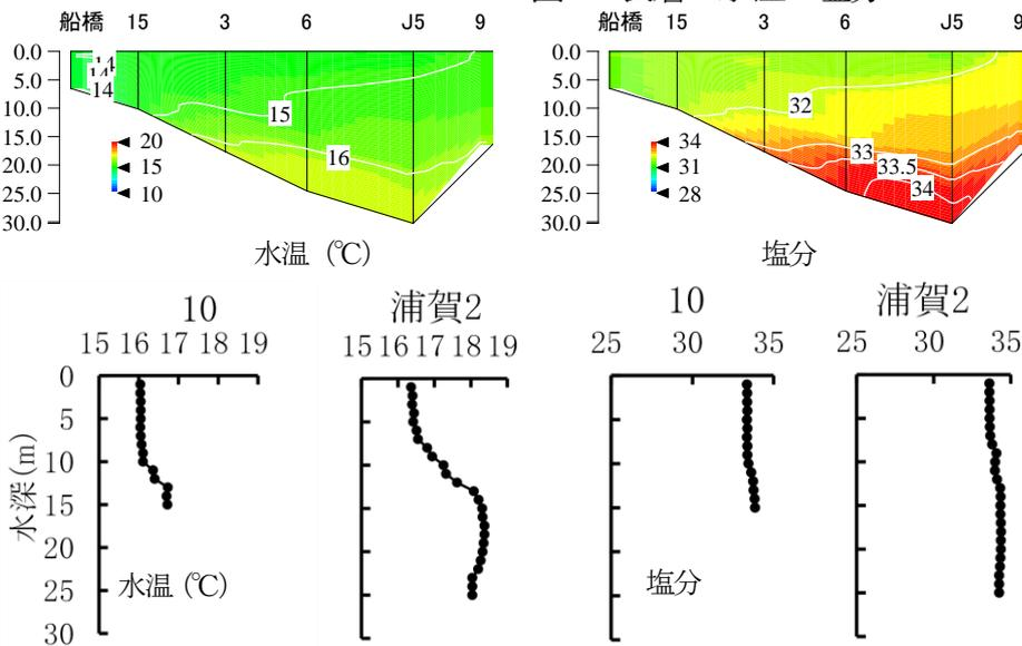
図2 縦断面の水温・塩分の鉛直分布
