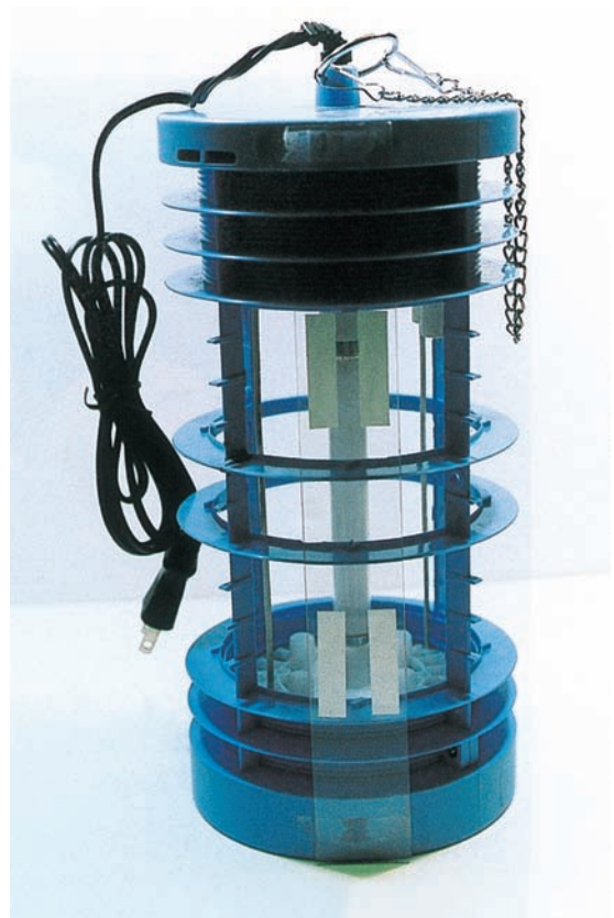
写真 - 6 透明なプラスチック板を取り付け 両面テープを4隅に貼り付ける
