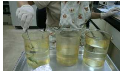
写真1-7 エタノール処理
