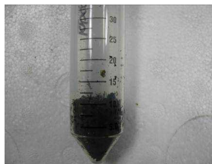
写真 2-6 遠沈管に入れた培養土 ※培養土は軽く押さえながら入れる
