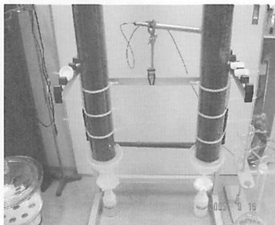
写真 5-2 牛ふん炭カラム試験における採水状況
