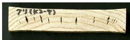
写真3 断面変形・内部割れ（クリ）
