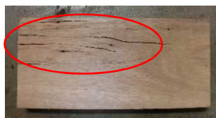
写真2 初期割れ（ユウカリ）
